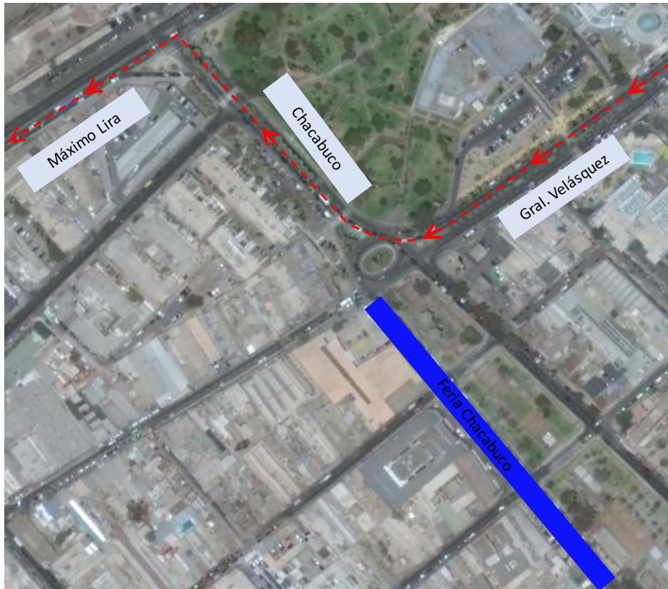
Figura N° 69: Modificación Trazado Sector Feria Chacabuco Servicio Línea 12 Sentido Ida
