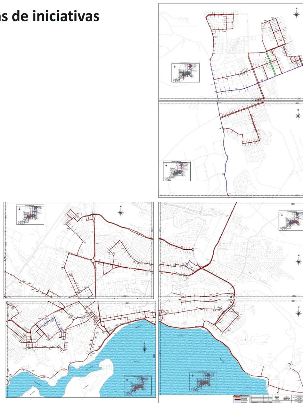
\*La figura muestra un ejemplo del plano con el estado de los pavimentos de la ciudad de Puerto Montt el que fue dividido en 13 láminas
